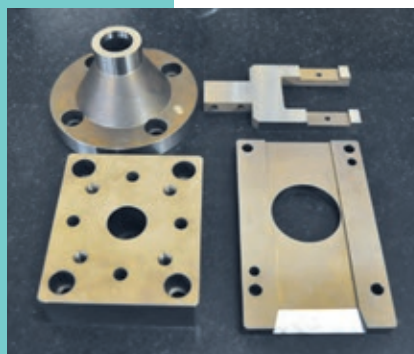
平面研削盤で作られる金型部品
