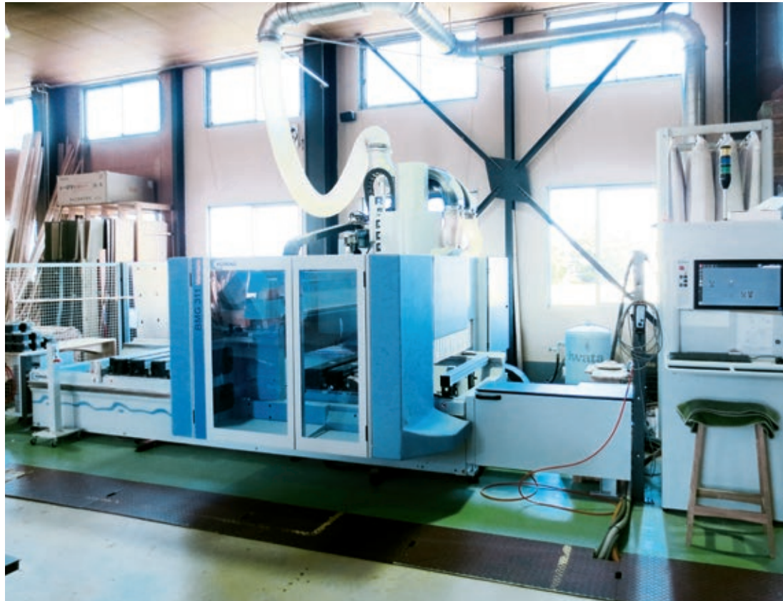
3次元加工を可能にする5軸制御CNCマシニングセンター
