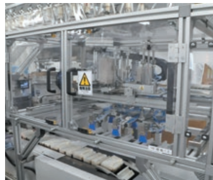
ゴム掛け機（手前）と自動包装機の連結部分
