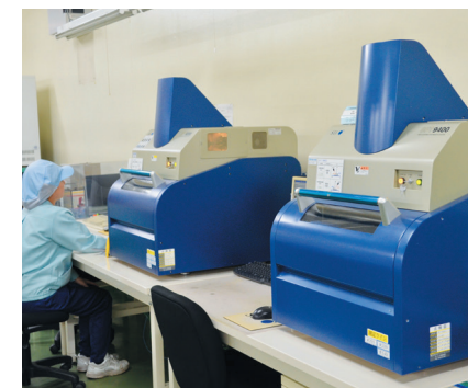
めっき厚規格を検査する蛍光X線膜厚計
