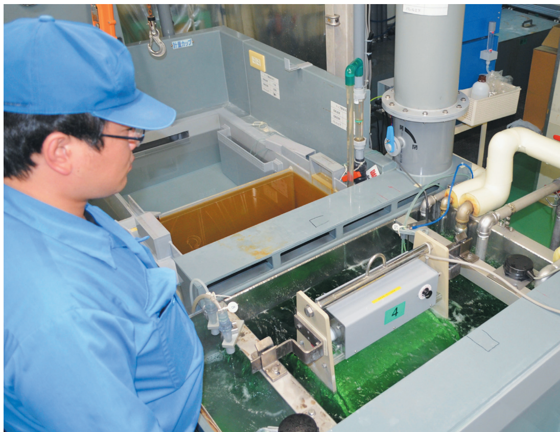
補助金で導入した無電解めっき装置
