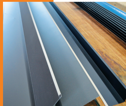
導入した機械で切断し、加工を施した軒先水切り
