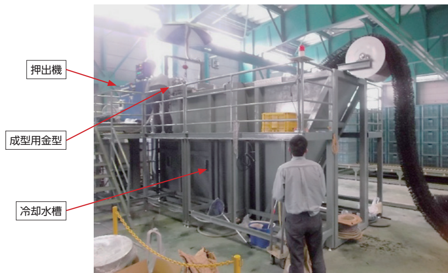
ヘチマ様接触材成型プラントの全景
