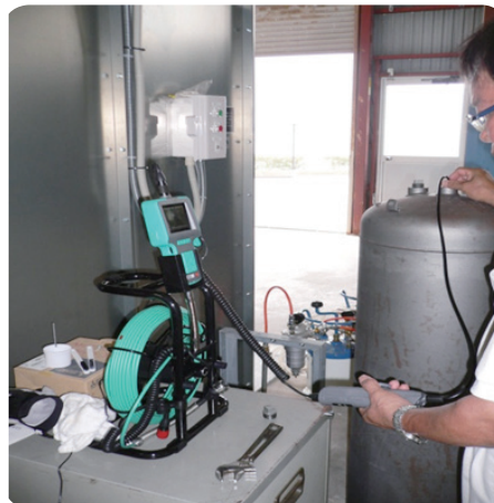
スコープによるボンベ内面検査
