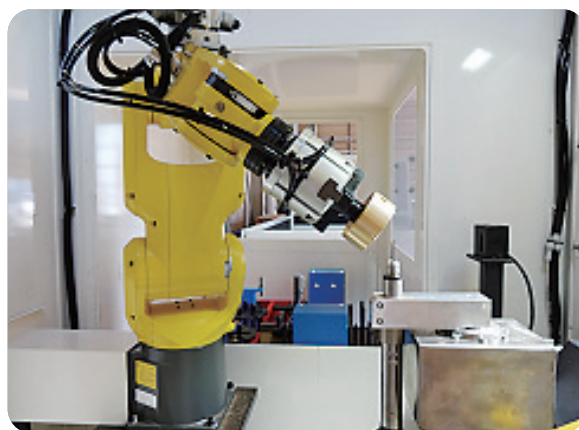
ロボットを使用してのバリ取り
