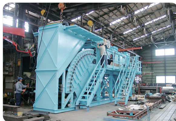
垂直コンベアヘッドフレーム
