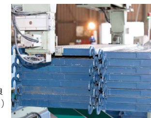
今まで手作業で行っていたケレン後の資材の積み上げは、自動で対応できるように。
