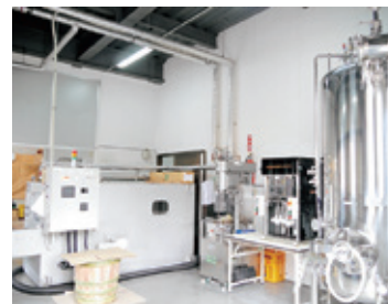
カーボネーションタンク、充填機などの低アルコール発泡酒類製造設備
