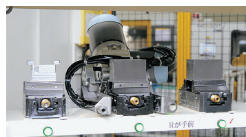
ワークを付けた治具をつかむロボット
