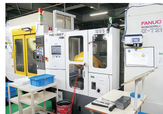
5軸マシニングセンター2台+ロボットの自社ブランド製品
