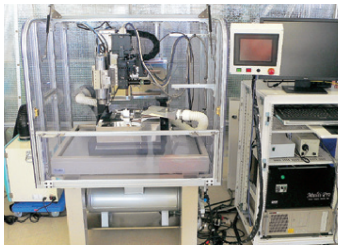
精密加工技術応用 金属内部構造解析「三次元内部構造顕微鏡」
