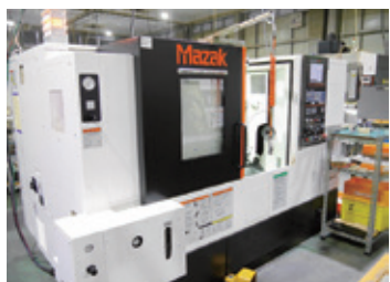
エアーマイクロチャック仕様のNC加工機
