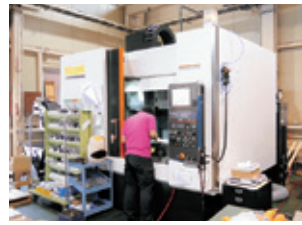
高速・高精度門型マシニングセンター
