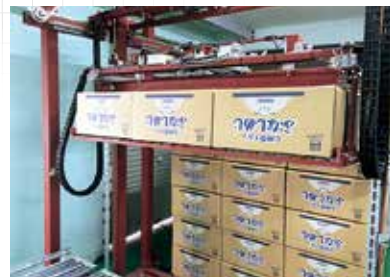
省力化を実現したダンボール積み上げ機
