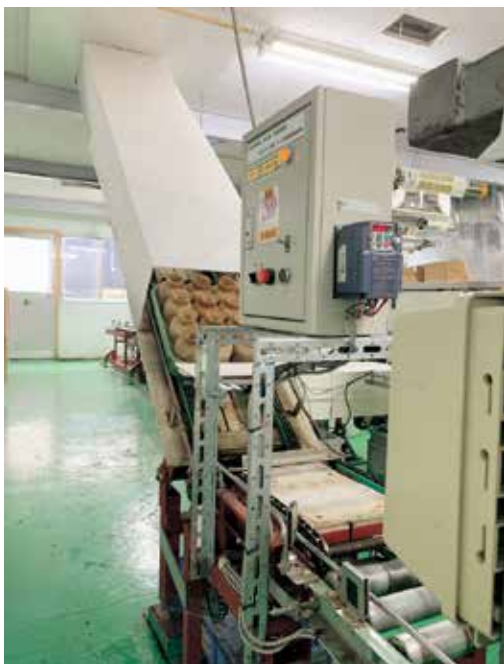
収穫済み搬送ライン（別棟次工程への搬送コンベア）
