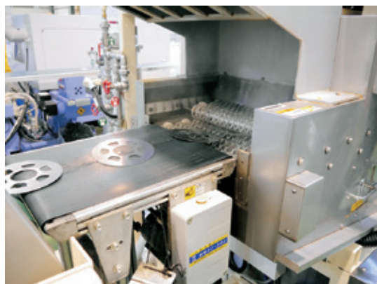
バリ取り機・洗浄機・XYレベラー 一貫ライン
