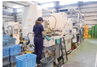
多板クラッチ用コアプレートの2次加工ライン
