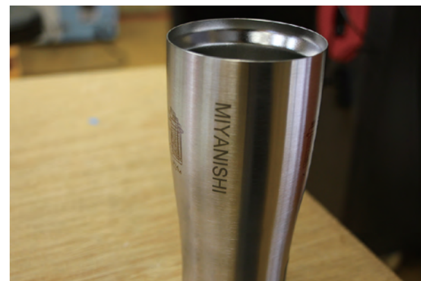
加工機に備え付けられたパソコンに打ち込んだ文字をすぐに印字することもできる
