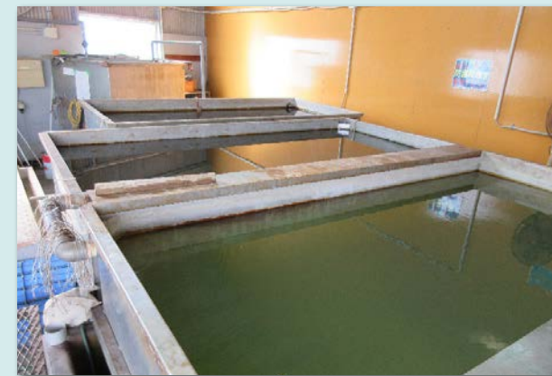
不純物の除去や耐食性を高める酸洗処理槽
