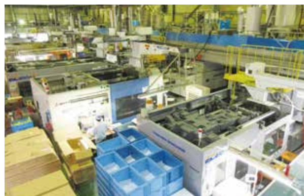
工場2階の混合機から直接成型機に材料を注入している
