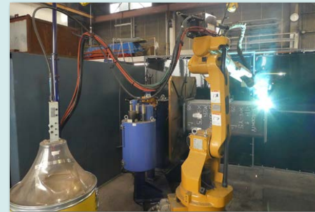
導入した自動溶接ロボット
