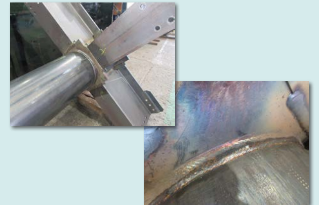
自動溶接ロボットにより制作された鉄骨及びその接合部
