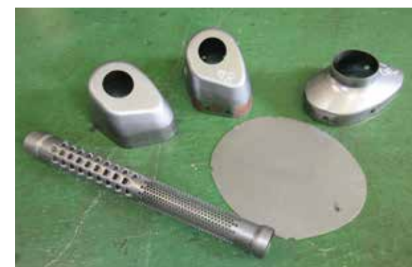
難加工材による深絞り加工製品
