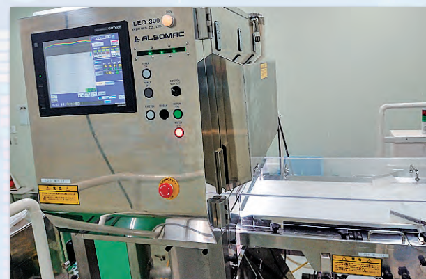
導入した色彩選別機により生産性が向上
