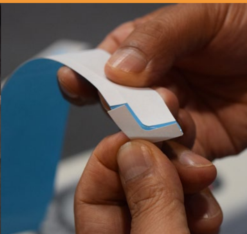
■ どこから剥がせるかが作業性に大きく影響する
