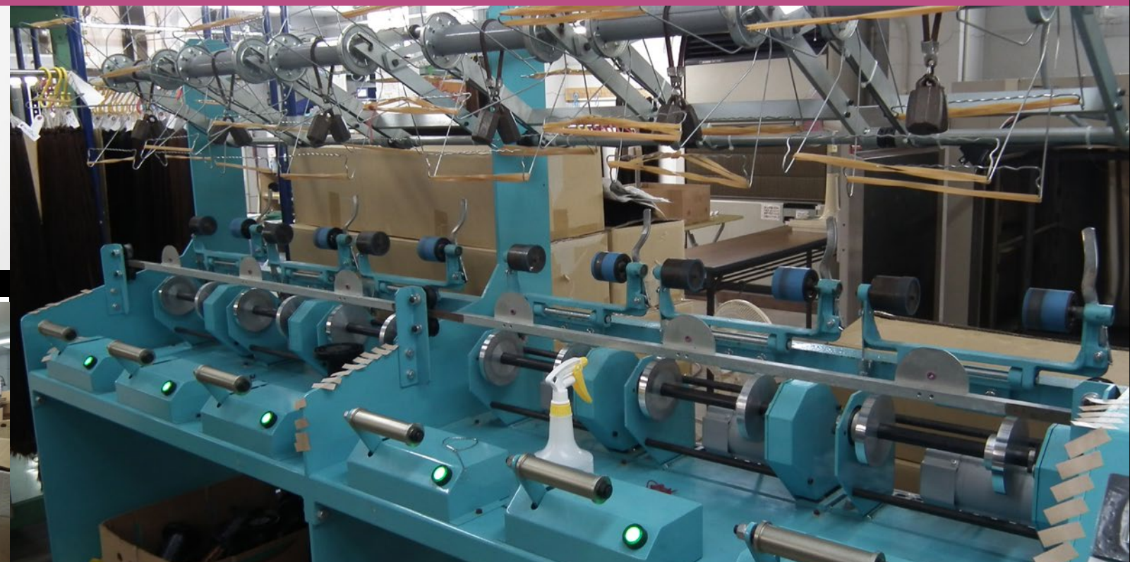
改良型のワインダーを導入。生産能力が従来比1・5倍と大幅に拡大した
