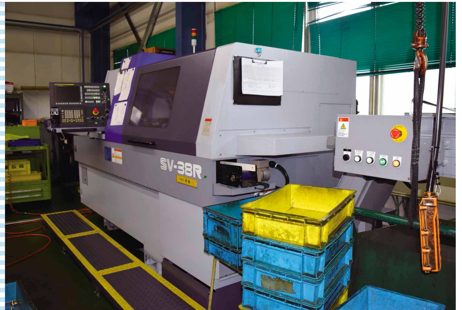
CNC自動旋盤を導入。素材の切断と穴開けを一工程に集約することでコスト削減につなげた
