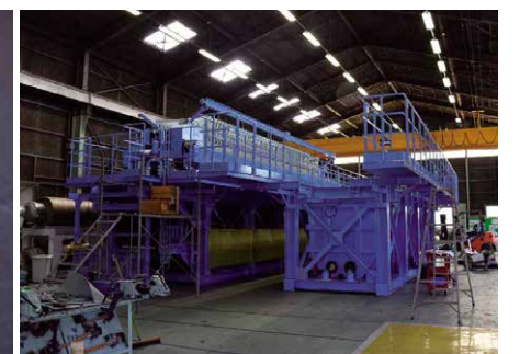
公共工事向け大型フィルタープレス
