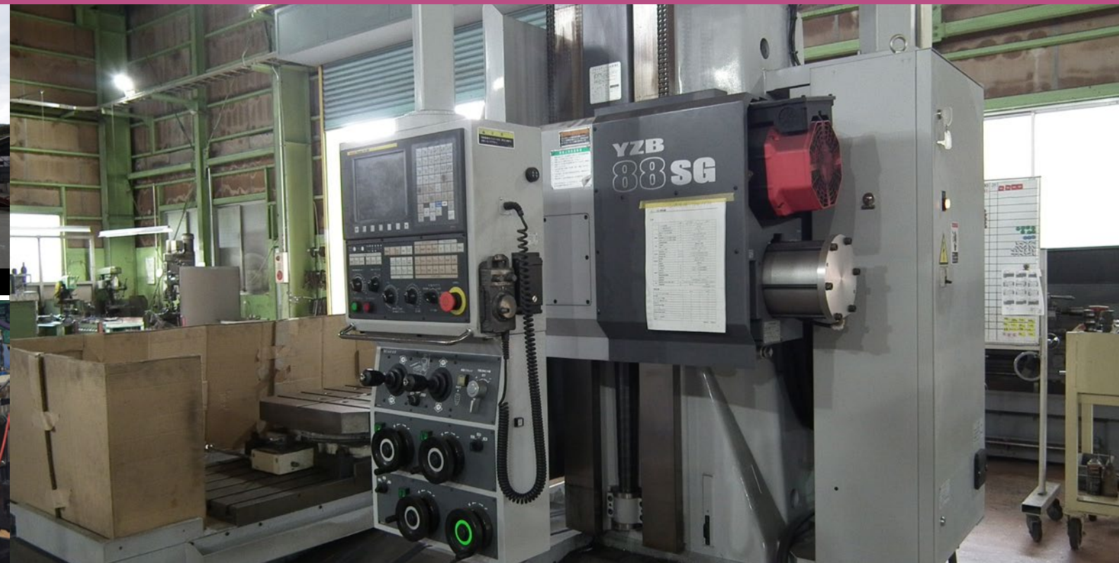
導入した横型フライス盤。横型でしかできない仕事も受注できるようになり、事業の幅が広がった
