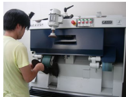
仕上げ加工はグラインダーを使った手作業で行う
