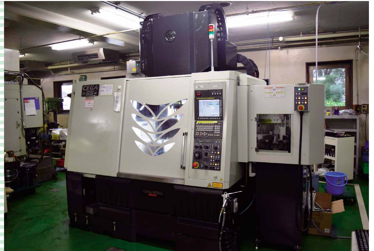
ものづくり補助金で導入した5軸加工機。高精度・高速・微細な加工を安定してできる
