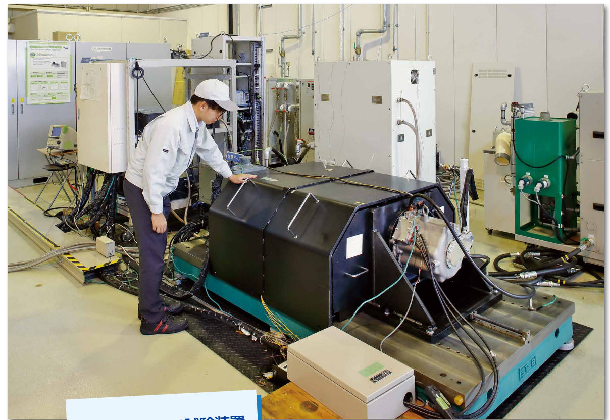
省エネ型モータ試験装置 を実現するDC電力循環 回生システムの開発
