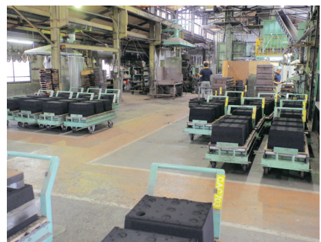
図2 自動造型機により大量生産した砂型
