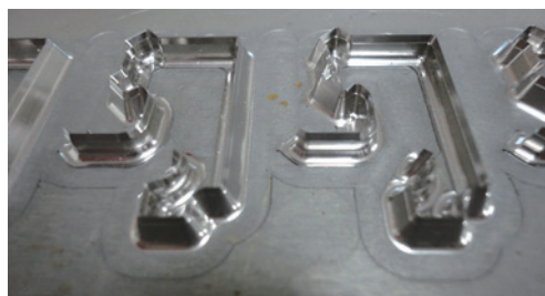
図6 彫刻刃：焼入鋼への加工
