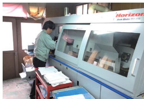
図2 最新型無線綴製本機
