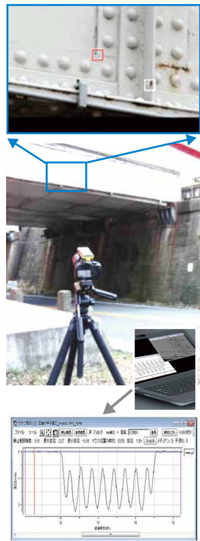
鉄道橋のたわみ計測風景
