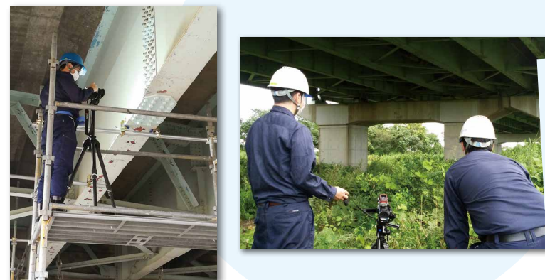
鉄道橋のたわみ計測風景
