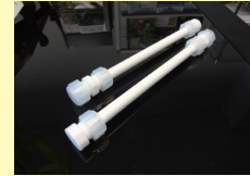
規則性ナノ多孔質セラミック分離膜基材（本事業試作品）
