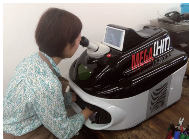
レーザー溶接機の操作
