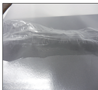
製版フィルムの破れ(はがれ)の状態
