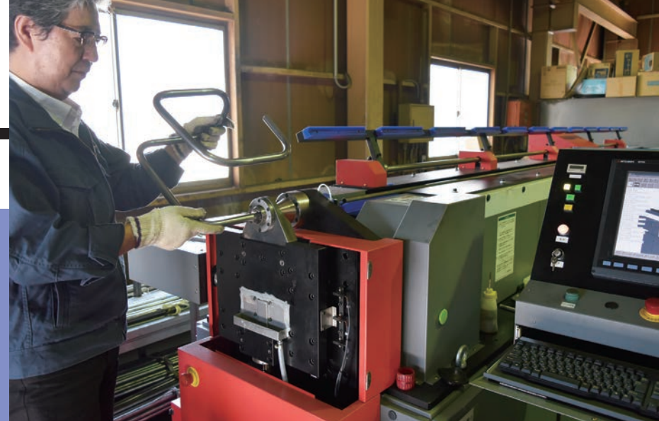
導入した3次元パイプベンダー
