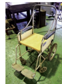
試作したフレームを付けた車いす
