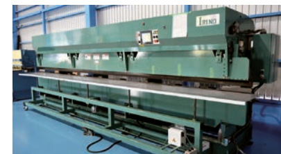
鋼板の曲げ加工をするベンダー
