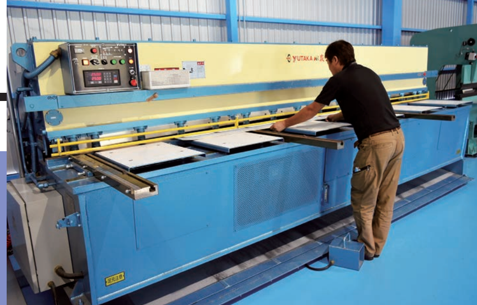
鋼板を切断するシャーリング
