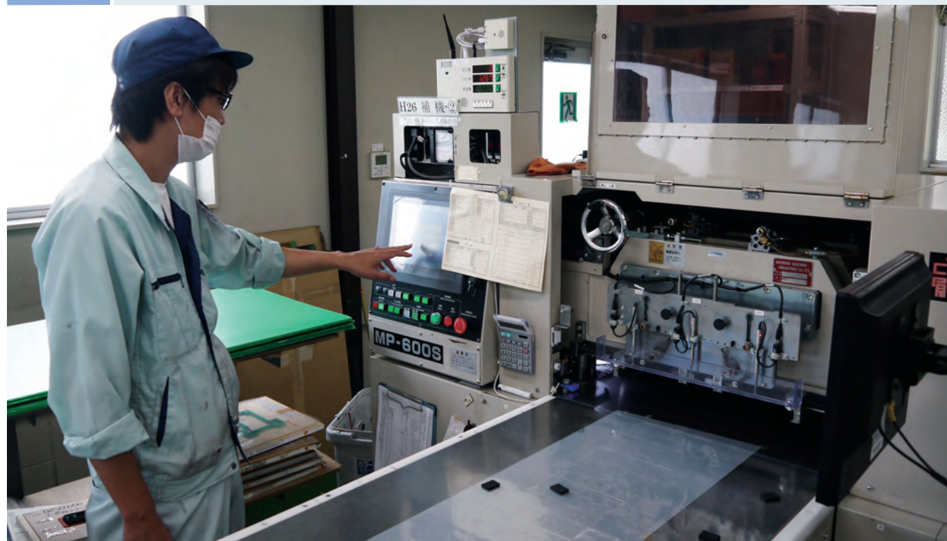
材料厚みを測れるトムソン加工機
