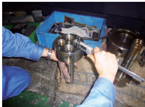
測定機を用いてしっかり検査する
