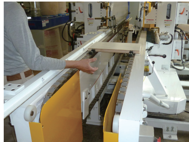
新設備の両端切断工程
