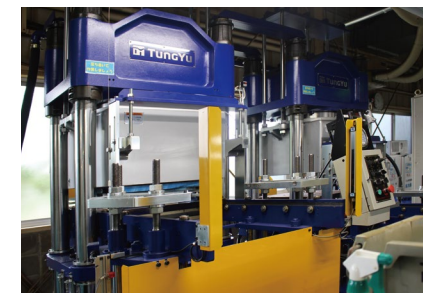
250トン2面分解全自動真空プレス
