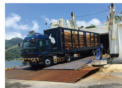
原木専用コンテナ(特許)での積み込み作業
