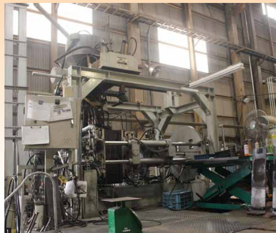
1 補助金導入で制作した大物中子製造装置 2 出荷を待つトラクターミッションケースの中子 3 水平割り反転取り出し方式の造型機械
