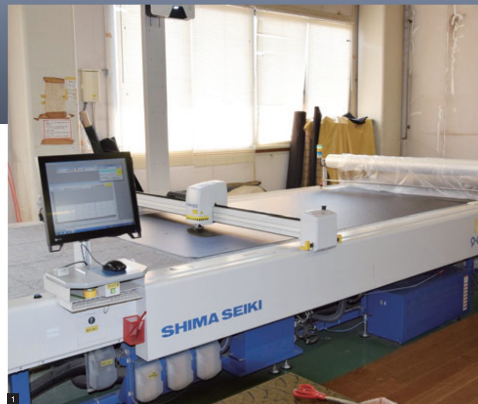
1、2、3 CAD/CAMによる自動裁断機
