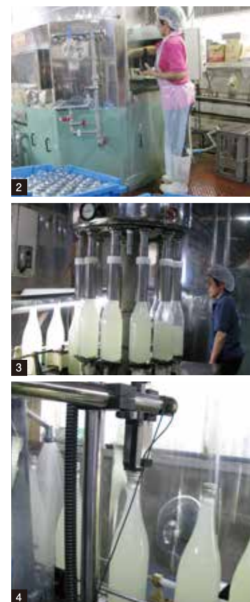
1 同社の主力商品「ゆずゆず」 2,3 今回導入したロータリー式洗瓶機一式 4 インクジェットプリンターですべての製品に独自のロット番号を印字するように
