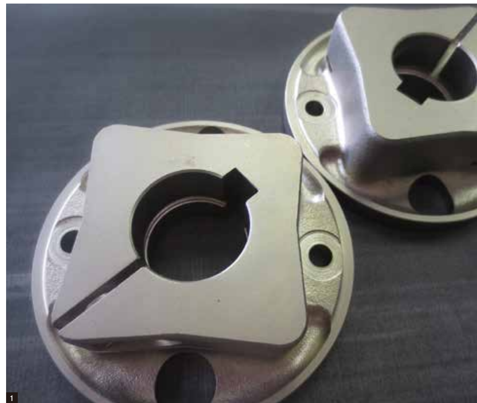
1 仕上がった製品 2,3 現状の機能性を確保しつつ、軽量化のためにめっき厚を可能な限り薄くするため、無電解ニッケルめっきの多層化めっき設備を開発
