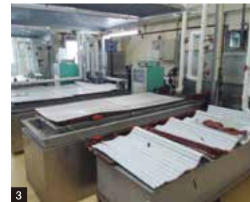
1 仕上がった製品 2,3 現状の機能性を確保しつつ、軽量化のためにめっき厚を可能な限り薄くするため、無電解ニッケルめっきの多層化めっき設備を開発
