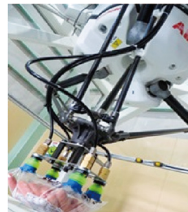
ウィナーのパッケージを掴むパラレルリンクロボット
