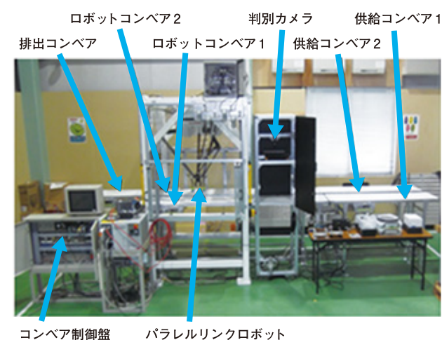
パラレルリンクロボット 評価システム
